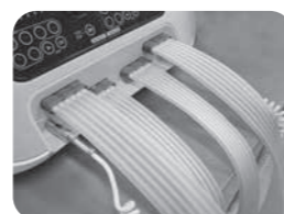
Фото соединения шлангов и аварийного выключателя (UAM-8500).
